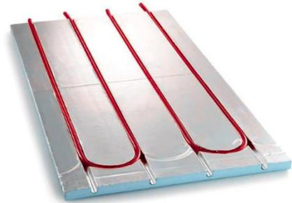
Das Plattenmaterial besteht aus XPS 500 (Druckfestigkeit 50 t/m<sup>2</sup>) und einer 99,7 %-igen Aluminiumfolie zur optimalen Wärmeverteilung.
